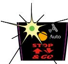
Este modo se utiliza cuando se ha realizado previamente una conexión con un sistema GPS que gestiona automáticamente las secciones.
