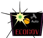
Ce mode est à utiliser quand vous avez au préalable réalisé un branchement avec un système GPS qui permet une gestion automatique des sections.
